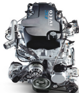
Motor de gas natural comprimido F1C de 3 litros
